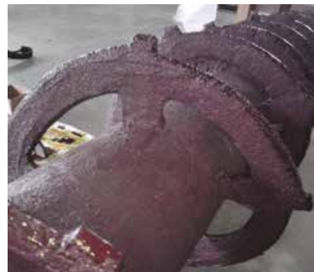
Transportador sinfín recubierto con Belzona 1811
