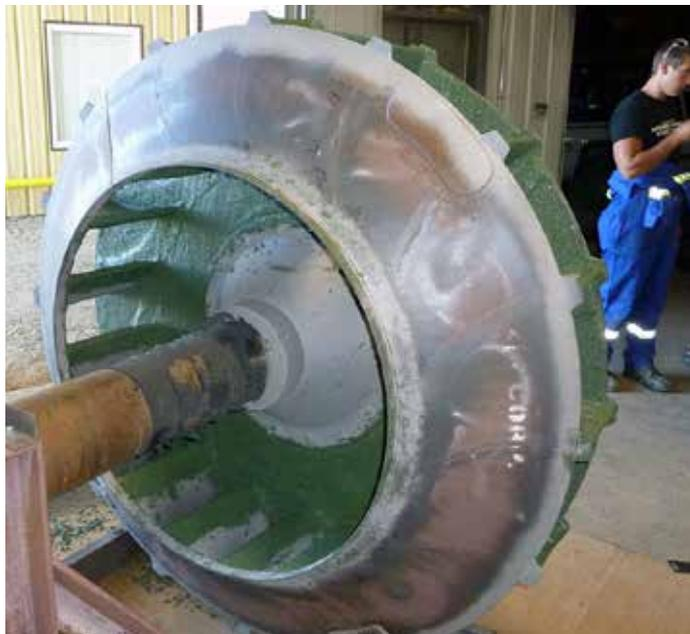
Belzona 1813 es un recubrimiento de reparación y protección de dos componentes diseñado para superficies expuestas al ataque abrasivo a temperaturas de hasta 200 °C
