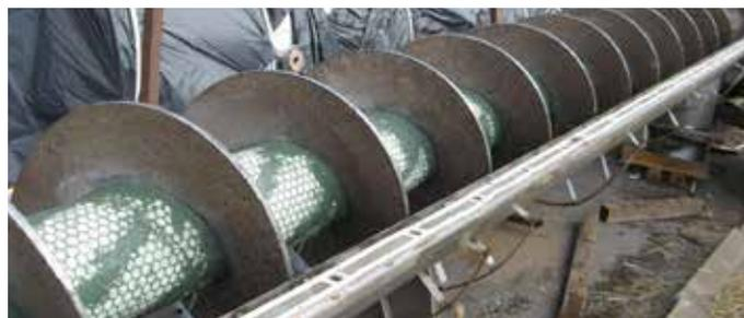
El transportador sinfín reparado con Belzona 1813 y tejas de alúmina
