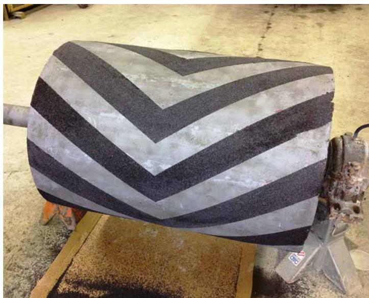
Belzona 1821 (Fluid Metal) es un sistema antideslizante utilizado para adherir los agregados Belzona 9211 (Supergrip), Belzona 9221 (Surefoot White) o Belzona 9231 (Surefoot) a la superficie de maquinarias y equipos.
