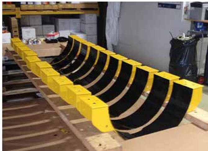
Recubrimiento de abrazaderas en la zona de salpicadura
