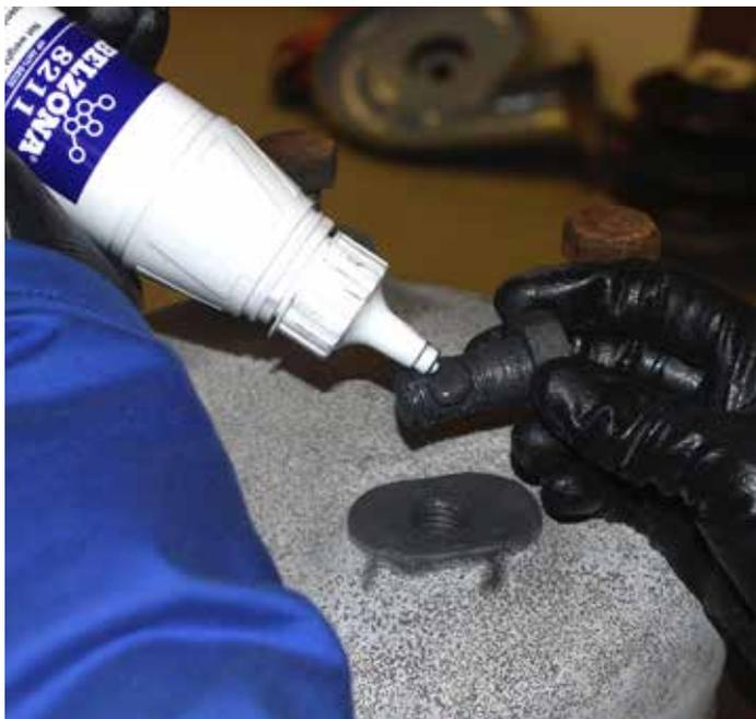
El compuesto Belzona 8211 (HP Anti-Seize) es un tratamiento antiadherente de alto rendimiento que evita los atascos y engranes en el acoplamiento de componentes sometidos a altas temperaturas, corrosión, productos químicos y enclavamientos mecánicos.
